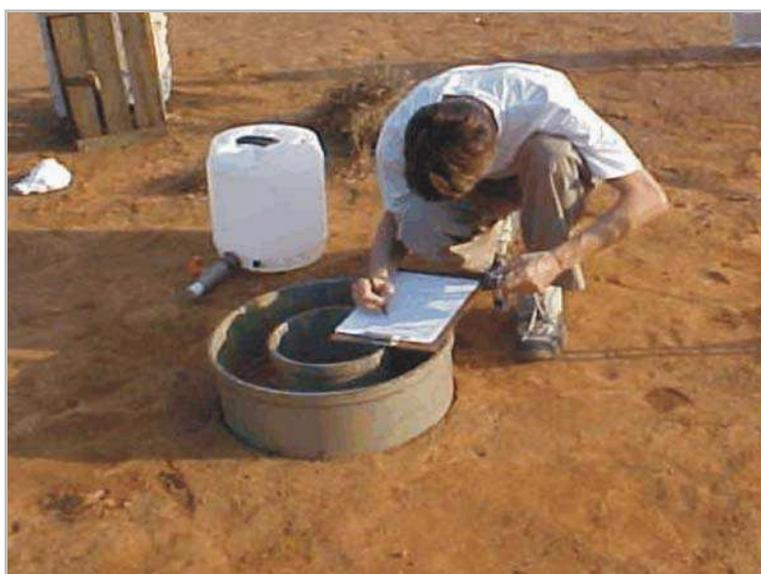
**Figura 3 - Ensaio de infiltração pelo método dos anéis concêntricos.**
