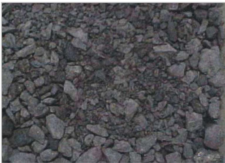
**Figura 17 - Rejeito piritoso testado nos lisímetros.**
