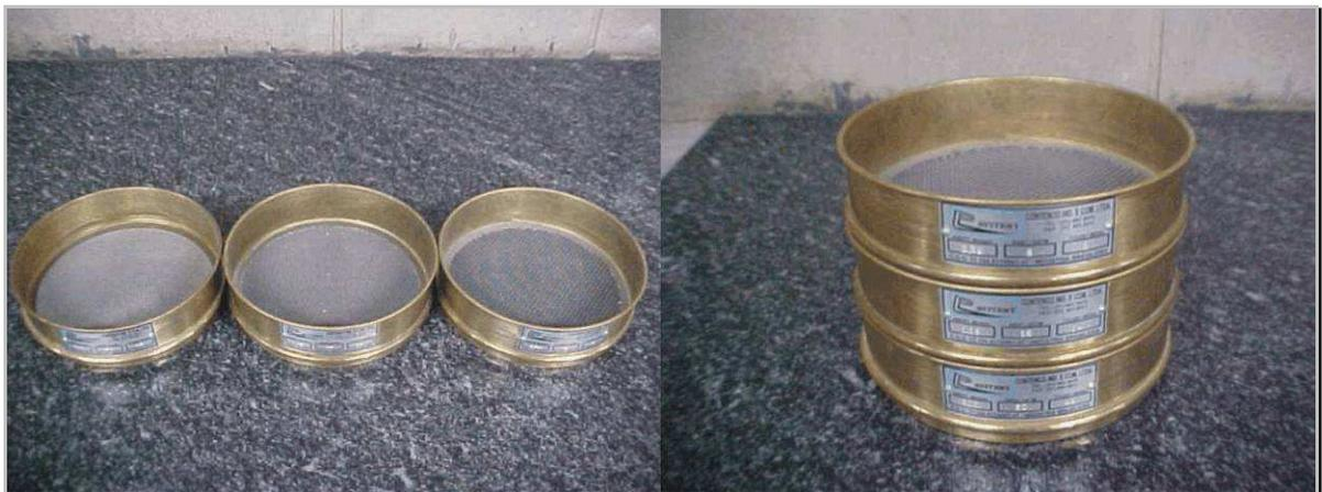
**Figura 18 - Peneiras utilizadas nos testes de separação dos materiais filtrantes.**
