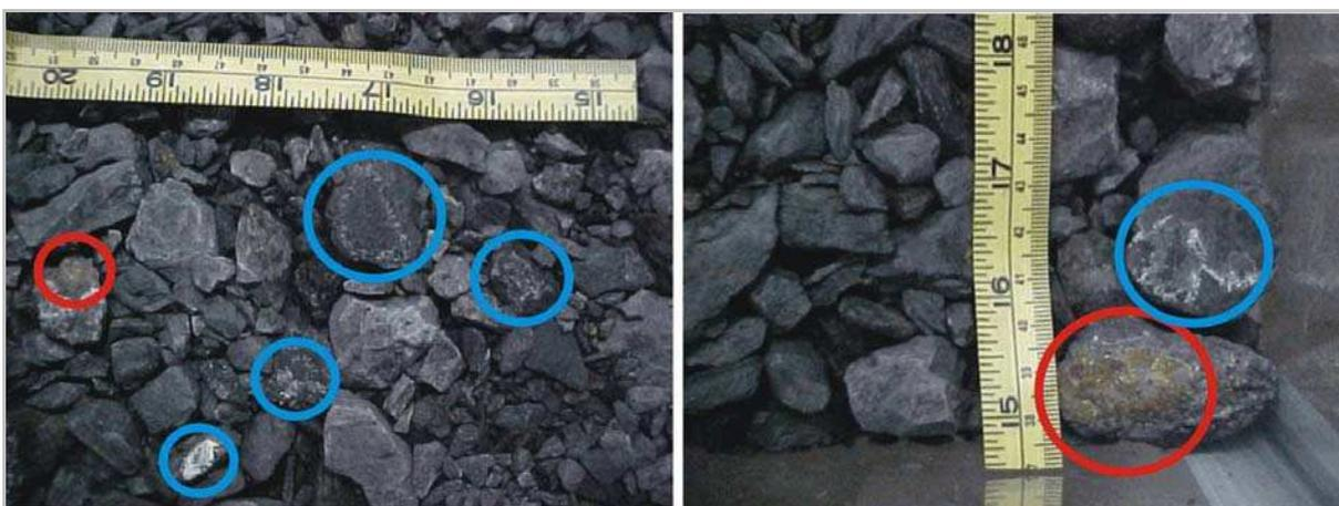
**Figura 20 - Reações ocorridas no ensaio realizado no lisímetro 1.**
