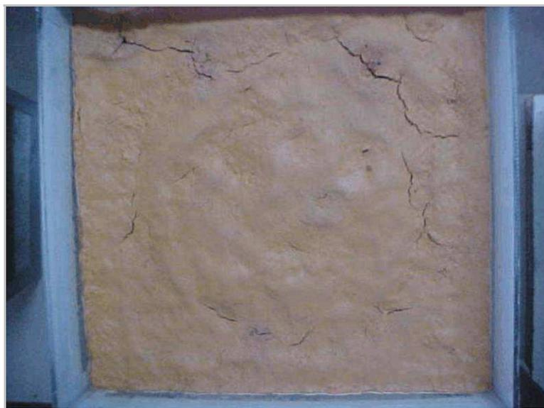
**Figura 21 - Vista superior da camada superficial de solo do lisímetro 2, demonstrando fissuras.**
