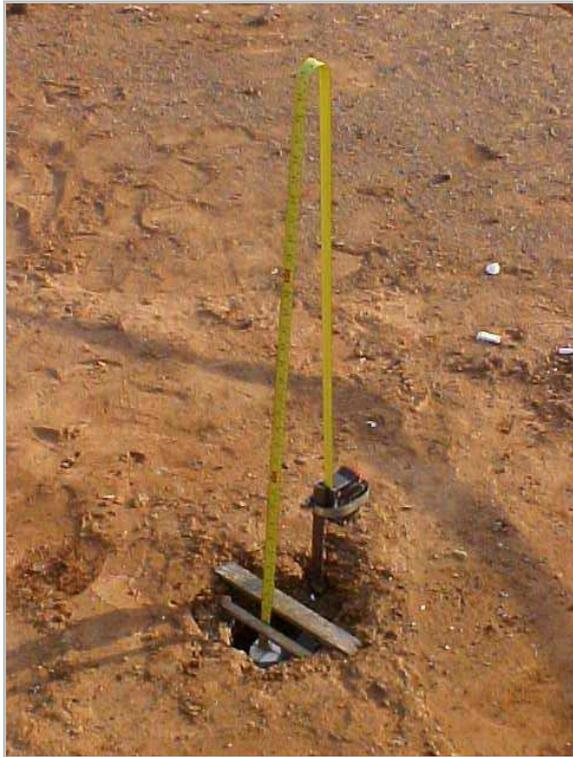
**Figura 4 - Ensaio de permeabilidade pelo método do trado invertido.**
