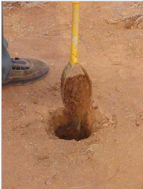
**Figura 5 - Perfuração do buraco para ensaio de permeabilidade.**
